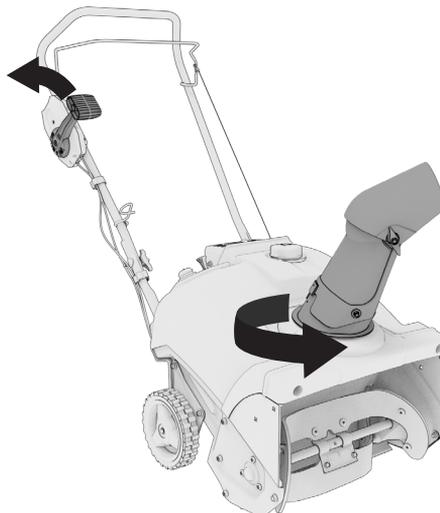
2. Pour régler l'angle du déflecteur vers le haut ou vers le bas, utilisez les poignées du bouton pour desserrer. Une fois l'angle souhaité défini, serrez les poignées des boutons pour fixer l'angle. NE PAS régler l'angle du déflecteur si le moteur tourne.
